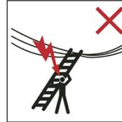
Leiter nicht im Bereich elektrischer Spannung oder in der Nähe von spannungsführenden Leitungen verwenden
