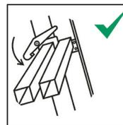
Auf die sichere Funktion von Abhebesicherungen bei mehrteiligen Leitern achten
