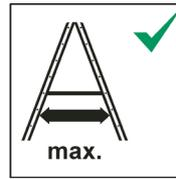
Spreizsicherung (zugfeste Verbindung) muss bei Stehleitern gespannt sein
