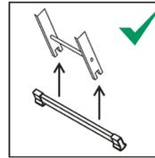
Sofern die Leiter mit einer Traverse ausgestattet ist muss diese zwingend vor der ersten Nutzung dauerhaft montiert werden
